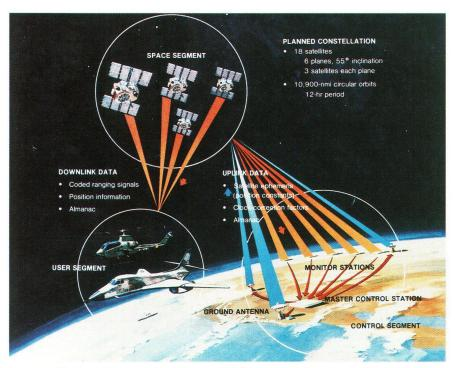
Abb. 5.: Die drei Elemente des Navstar-GPS Systems: Das Raumsegment mit den 18 Satelliten, das Bodensegment mit den Bodenstationen zur Satellitenkontrolle und das Nutzersegment, wie Flugzeuge, Schiffe usw. (Foto: Rockwell Int. / Archiv Schmidt.)
