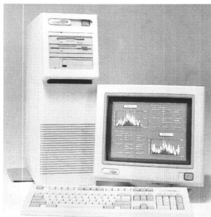
Die Compaq Systempro/LT Familie bietet Ihnen – besonders für kleine und mittlere Arbeitsgruppen – eine ideale Server- und Host-Plattform. Sie werden standardmäßig mit einem 32-Bit-Intelligent Drive-Array-Controller (IDA) und zwei Festplatten ausgeliefert. Der Datendurchsatz mit dem Drive-Array-Subsystem ist vierfach schneller im Vergleich zu einem nicht als Array angeordneten System.
