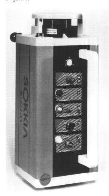
Das Gerät justiert sich von der Horizontalund Vertikalebene automatisch und kann auf Lot- oder Richtstrahl rechtwinklig zur Rotationsebene umgeschaltet werden. Für schräge Anwendungen kann die Automatik abgeschaltet werden.
