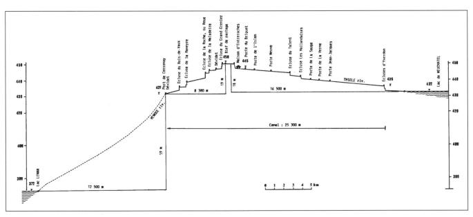
Abb. 1: Profil des Canal d'Entreroches.
