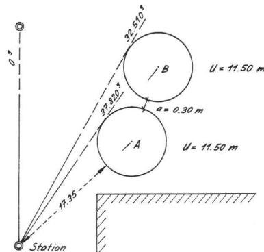
Berechnen Sie die Aufnahmeelemente der Punkte A und B.
