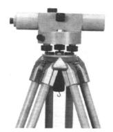
Abb. 5: Ingenieur-Nivellier Zeiss-Ni 2 (1950). Erstes Nivellier mit automatischer Horizontierung der Ziellinie.
