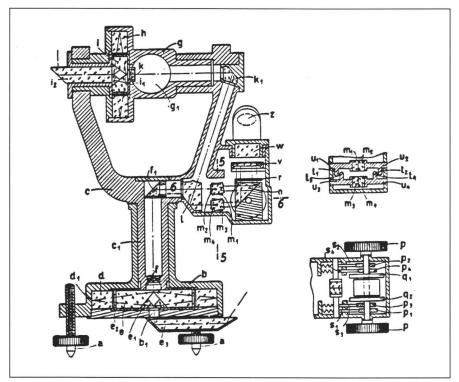
Abb. 3: Optisches Schema des Zeiss-Theodolit I von Heinrich Wild (1922). Erstmals sind diametrale Kreisstellen optisch zusammengeführt. Mittels Planplattenmikrometer erfolgt die Ablesung von Horizontal- und Höhenkreis unter Koinzidenz im Ablesemikroskop neben dem Okular.
