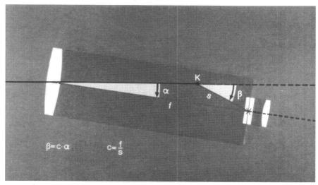
Abb. 7: Funktionsschema zur automatischen Horizontierung der Fernrohr-Visierlinie mittels Kompensator. Bei Neigung des Fernrohres um  $\alpha$  lenkt der Kompensator das Horizontbild innerhalb des Fernrohres um  $\beta$  = c x  $\alpha$  auf Fadenkreuz-Mitte zurück.
