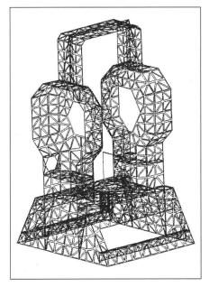
Abb. 4: Finite-Elemente-Struktur eines Theodoliten.
