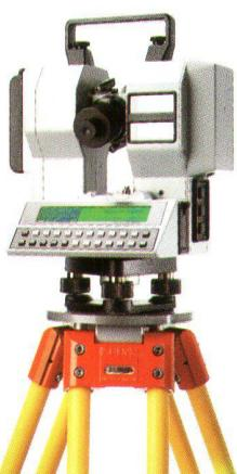
Luftdruck und Temperatur automatisch. Genauso automatisch korrigieren sie die Meßergebnisse unter Berücksichtigung dieser beiden Parameter.
