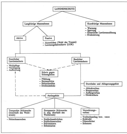
Abb. 2: Mögliche Schutzmassnahmen gegen Lawinen.
