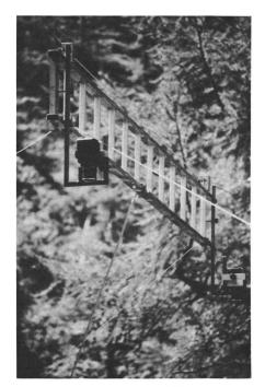
Abb. 3: Kameras mit Aufhängevorrichtung (Senkrechtaufnahmen).
