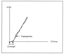
Abb. 7: Idealisiertes Trapezgerinne zur Schätzung des hydraulischen Radius (Skizze).
