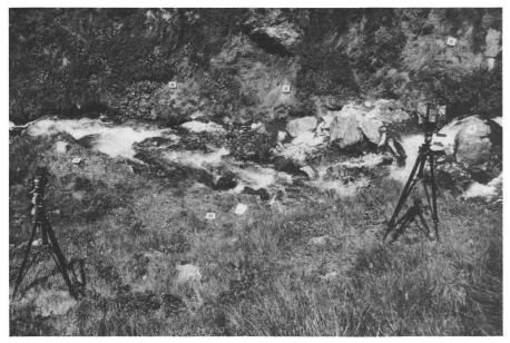
Abb. 4: Kameras auf Stativen am Walibach (Schrägaufnahmen).
