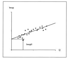
Abb. 6: Funktion der mittleren Wasserspiegelbreiten und der Durchflussmengen (Skizze).
