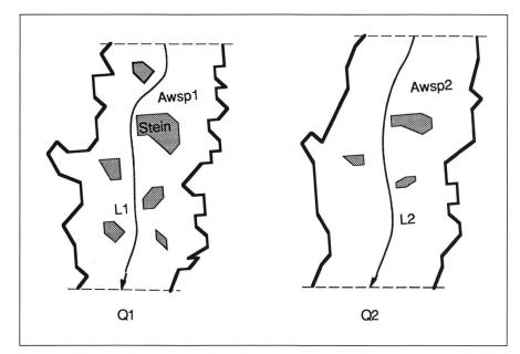
Abb. 5: Wasserspiegeloberfläche bei unterschiedlichen Durchflussmengen (Skizze, Q1 <Q2).
