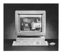
Neu ist von DEC ein leistungsfähiges X-Window Terminal mit hochauflösender Farbgrafik erhältlich. Dieses Terminal ermöglicht gleichzeitig die Arbeit mit mehreren DECwindowsund X-Windows-Anwendungen, die auf unterschiedlichen Hostrechnern unter verschiedenen Betriebssystemen im Netzwerk laufen. Ein leistungsstarker CVAX-Prozessor sowie ein SPX-Grafikprozessor sorgen für einen schnellen Bildaufbau.
