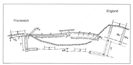
Abb. 9: Auswirkung der unterschiedlichen Höhensysteme.
