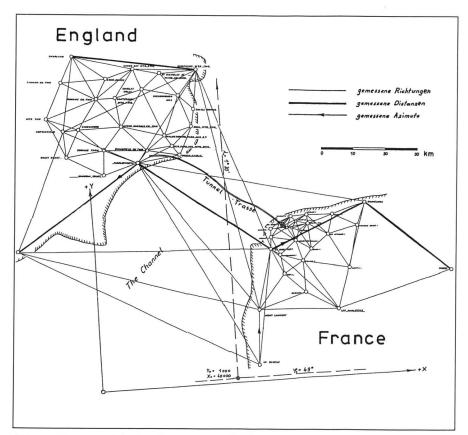
Abb. 7: Trigonometrisches Lagenetz CTG 86 des Eurotunnels.
