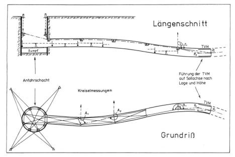
Abb. 11: Tunnelfestpunktsystem zur geometrischen Führung der Tunnelvortriebsmaschinen.
