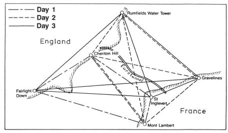
Abb. 8: Kanalübergreifende GPS-Messungen durch NORTECH-Survey.
