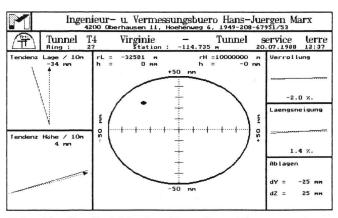
Abb. 14: Monitorbild des Tunnelbau-Führungssystems TUMA.
