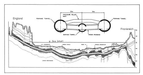
Abb. 4: Längenschnitt, Querschnitt und Geologie des Eurotunnels.
