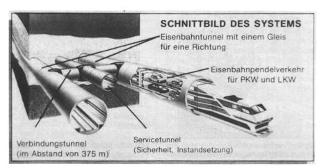
Abb. 3: System des Eurotunnels.
