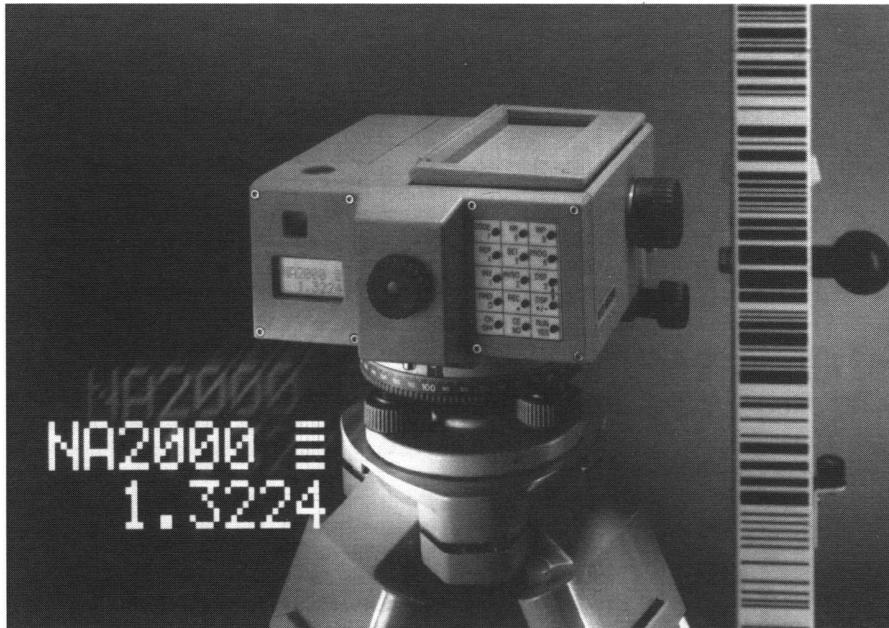
Abb. 1: Eine Nivellierlatte mit Strichcodeskala dient der Weltneuheit Wild NA2000 als Ziel. Durch elektronische Bildverarbeitung bestimmt das soeben mit dem «Photonics Excellence Award» ausgezeichnete Instrument die Höhe sowie die Distanz. Die elektronische Bildverarbeitung des Wild NA2000 ist dem menschlichen Auge überlegen: auch bei Hitzeflimmern, in der Dämmerung und selbst bei teilweise verdeckter Latte liest das Wild NA2000 Höhe und Distanz mit hoher Sicherheit automatisch ab.
