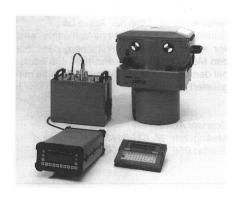
Auf der «geotechnica» (Köln 18.–21.9. 1991) stellte Carl Zeiss, Oberkochen, erstmals die Verbindung einer RMK TOP Luftbildkammer mit dem GPS (Global Positioning System) Satellitennavigations-System NAVSTAR vor. Die Kombination beider Systeme erlaubt es, den Aufwand an Vermessungsarbeiten deutlich zu reduzieren und damit die Kosten zu senken
