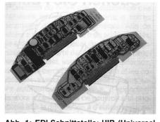
Abb. 1: EDI-Schnittstelle: UIB (Universal Interface Board), FDRA (Film Data Recording Alphanumeric).
