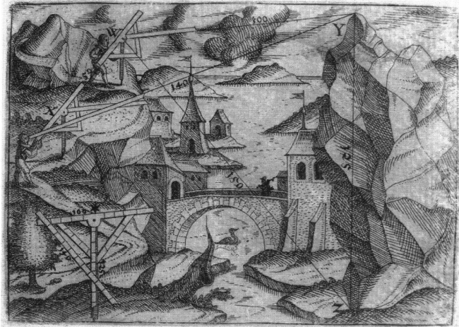
Abb. 5: Wie du eine Höhe eines Berges oder auf einem Berg in das Tal messen sollst.
