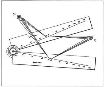
Fig. 11a, b: Marche à suivre pour tracer un angle de 56°.
