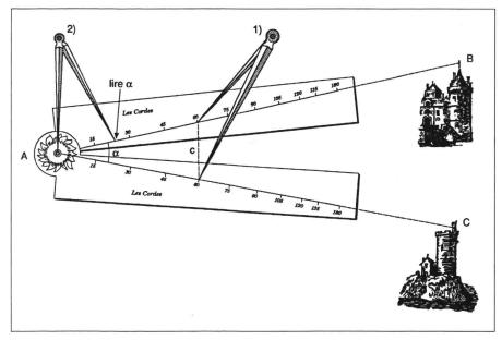
Fig. 15: Marche à suive pour mesurer un angle.
