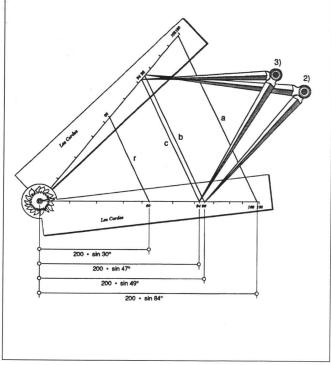
Fig. 17a, b: Marche à suivre pour déterminer l'éloignement d'un point inaccessible.
