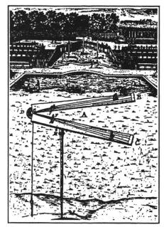
Fig. 13: Le compas de proportion, utilisé comme instrument topographique. On distingue bien sur cette gravure les accessoires nécessaires à un usage sur le terrain: pied, fil à plomb, pinnules. Gravure extraite de Manesson Mallet «La géométrie pratique» Paris 1702.
