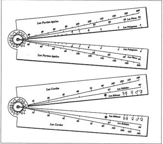
Fig. 4b, c: Schéma d'un compas de proportion classique; une face présente les lignes des parties égales, des plans et des polygones; l'autre, celles des cordes, des solides et des métaux.
