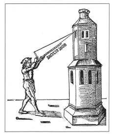
Abb. 1: Baculus Jacob (Jakobsstab) nach einer Darstellung in G. Reisch, Margarita philosophica, 1496. Der Zeichner dieses Holzschnittes hat die Handhabung des Gerätes überhaupt nicht verstanden und deshalb vollkommen falsch dargestellt (vgl. Abb. 13).
