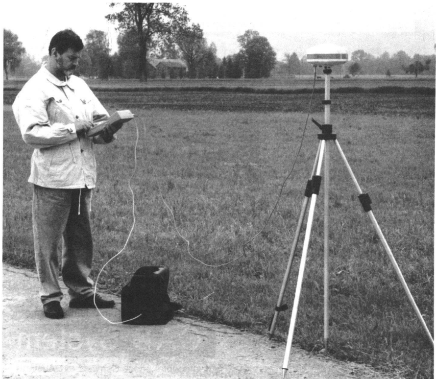
Abb. 2: Beispiel für Aufstellung mit Lotstock und Schnellstativ, für statische Vermessung «Rapid Static» oder «Reoccupation» (mobiler Empfänger).
