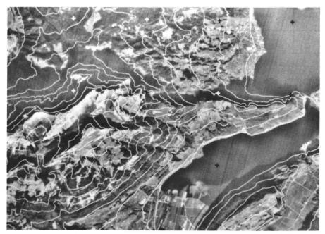
Abb. 3: Digitales Orthophoto mit überlagerten Höhenlinien und Karten-Gitterkreuzen. DTM-Daten: © Bundesamt für Landestopographie, Bern.
