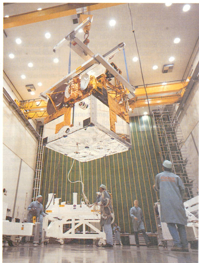
Abb. 8: Nutzlastmodul mit wissenschaftlichen Experimenten. Die Struktur wurde durch Contraves in Zürich gebaut. Quelle: ESA.
