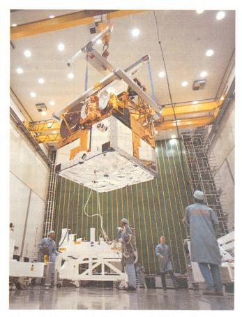
Abb. 8: Nutzlastmodul mit wissenschaftlichen Experimenten. Die Struktur wurde durch Contraves in Zürich gebaut. Quelle: ESA.
