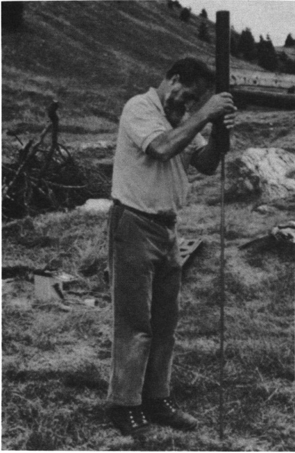
Abb. 2: Rammsondierung zur Bestimmung der Tiefe des anstehenden Felsens.
