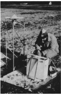
Abb. 7: Vor der eigentlichen Messkampagne im Netz wurden alle eingesetzten Empfänger auf der Teststrecke der L+T in Thun geprüft und die individuellen Offsets der Phasenzentren für alle Antennen bestimmt. Auf dem Bild ist auch ein Stahlpfeiler für die stabile Montage der Antennen zu erkennen.
