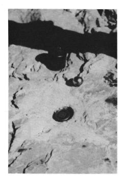
Abb. 4: Die Kontrollpunkte wurden durch Kappenbolzen versichert. Für die exakte Zentrierung wird ein mit einem Millimeterraster versehener Einsatzzapfen (sog. «Le Pont-Zapfen») in den Kappenbolzen eingesetzt. Eine in den Bolzen eingesetzte Stahlkugel mit konstantem Durchmesser definiert die exakte Referenz für die zu nivellierende Antennenhöhe.
