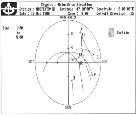
c) Verteilung der GPS-Satelliten über 15° Elevation in der Zeit zwischen 01:00 und 05:00 Uhr GMT/UTC.
