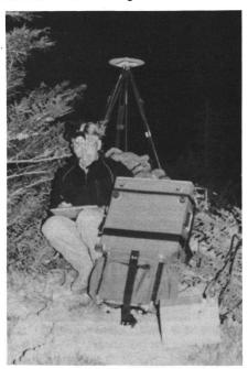
Abb. 6: Operateur mit einem auf dem Tragräf montierten GPS-Empfänger. Im Vordergrund die Batterie, im Hintergrund die Antenne. Wegen der geringeren lonosphärenaktivität wurde der Zeitpunkt der GPS-Messungen so gewählt, dass diese nachts bis in die frühen Morgenstunden stattfanden.
