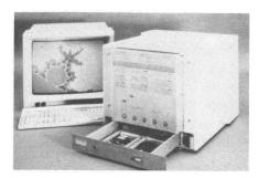
Die hochauflösenden 19" Monitore der PCD und der Ruggedized Serie werden mit Hilfe einer Einschubkassette zum Terminal. Die Einschubkassette beinhaltet Terminalelektronik, Grafikprozessor, Emulationsfirmware und die entsprechenden Schnittstellen zur Aussenwelt. Die DEC und Tektronix kompatiblen Terminals sind für erschwerte Umweltbedingungen konzipiert. Bei extremen Fremdfeldeinflüssen sind Versionen mit MU-Metallabschirmung erhältlich. Für Sicher-
