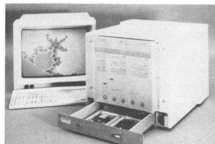
Die hochauflösenden 19" Monitore der PCD und der Ruggedized Serie werden mit Hilfe einer Einschubkassette zum Terminal. Die Einschubkassette beinhaltet Terminal elektronik, Grafikprozessor, Emulationsfirmware und die entsprechenden Schnittstellen zur Außenwelt. Die DEC und Tektronix kompatiblen Terminals sind für erschwerte Umweltbedingungen konzipiert. Bei extremen Fremdfeldeinflüssen sind Versionen mit MU-Metallabschirmung erhältlich. Für Sicher-
