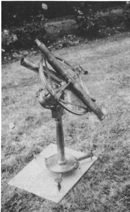
Fig. 4: L'I.G.N. possède dans ses collections un cercle répétiteur de Lenoir qui pourrait avoir été l'un des deux cercles de Méchain. Mais l'identification certaine est impossible quoique non invraisemblable. Les photographies ont été prises par Monsieur Louis Moucquet, Ingénieur des Travaux Métrologiques.
