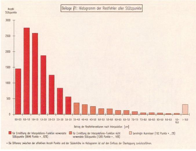
Abb. 4: Histogramm der Restfehler aller Stützpunkte (Resultatshistogramm).
