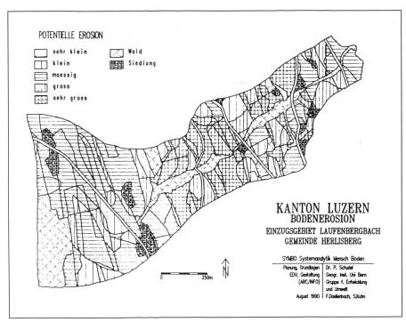
Abb. 3: Potentielle Erosionsgefährdung im Einzugsgebiet des Laufenbergbaches.
