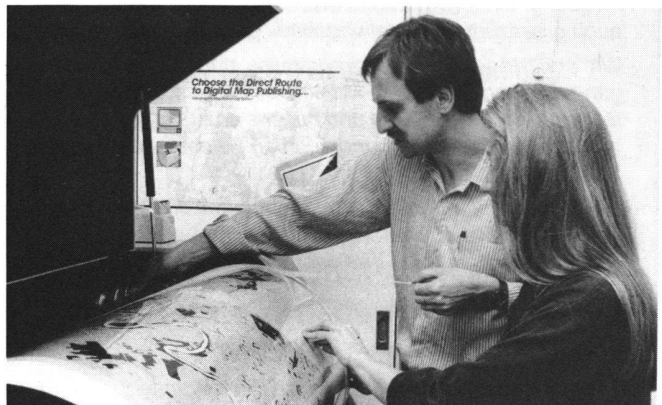
Abb. 2: Orell Füssli Mitarbeiter beim Aufspannen einer Vorlage am Optronics 5040 Scanner/Laserplotter.
