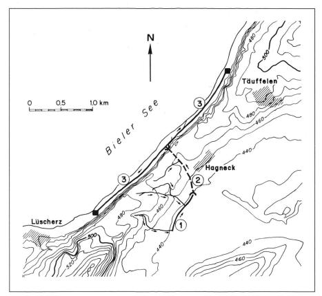
Abb. 5: Der Römerstollen als Wasserversorgungsstollen. (1) Freilaufkanal mit Bachwasserfassungen. (2) Stollen. (3) Freilaufkanal, der in einem Gutshof am Bielersee endet.
