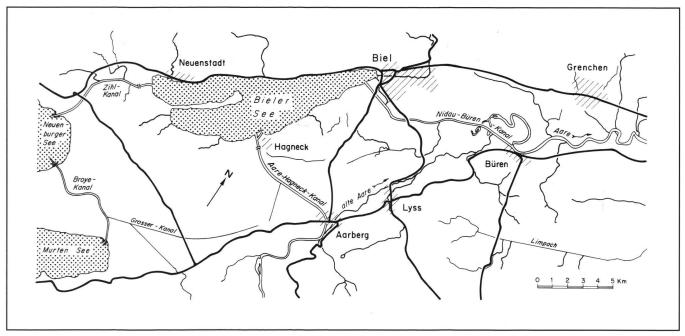
Abb. 2: Heutige Situation des Berner Seelandes. Seit der I.Juragewässerkorrektion 1868–1891 fliesst die Aare von Aarberg in einem Kanal in den Bielersee (Aare-Hagneck-Kanal). Beim Durchstich dieses Kanals durch den Seerücken bei Hagneck wurde der Römerstollen freigelegt und zerstört.
