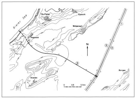
Abb. 7: Der Römerstollen als Entwässerungsstollen. (1) Römerstrasse (Strang 1). (2) Strassenentwässerungsgräben. (3) Entwässerungskanal. (4) Stollen.
