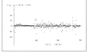
Abb. 3b: Änderung der ionosphärischen Refraktion;  $\Delta(L_1-L_2)/Minute$ .
