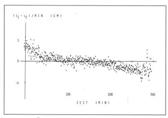
Abb. 1b: Änderung der ionosphärischen Refraktion;  $\Delta(L_1-L_2)/Minute$ .
