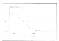
Abb. 6: Zeitliche Korrelation der  $L_4$ -Residuen, Satellit 6 (normale lonosphärenverhältnisse).
