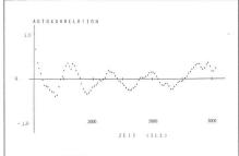
Abb. 7: Zeitliche Korrelation der  $L_4$ -Residuen, Satellit 6, (starke kurzperiodische Schwankungen).
