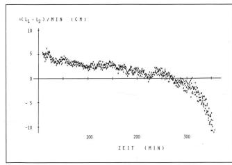
Abb. 2b: Änderung der ionosphärischen Refraktion;  $\Delta(L_1-L_2)/Minute$ .
