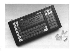
Für die Datenerfassung im Feld hat die Microport GmbH, Paderborn einen neuen leistungsstarken, feldtauglichen Handcomputer entwickelt. Das MS-DOS kompatible Gerät lässt sich anwenderspezifisch selbst programmieren.
