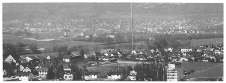
Abb. 6: Panorama des Trasseeverlaufes der Transjurane zwischen Courrendlin und Delémont: links Eisenbahnlinie, Kantonsstrasse Delémont–Courrendlin und Birs, rechts Tunnelportal (im Vordergrund: Courrendlin; im Hintergrund: links Delémont, rechts Courroux).
