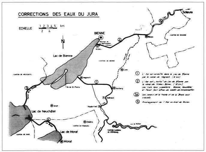
Fig. 2: Corrections des Eaux du Jura. ① L'Aare est conduite dans le lac de Bienne par le Canal de Hagneck: 8 km (1ère Correction 1870–1890). ② L'Aare est «sortie» du lac de Bienne par le canal de Nidau–Büren (18 km) (1ère correction). ③ et ④ 2e correction (1950). Les canaux de la Thielle et de la Broye sont élargis et approfondis. ⑤ Aménagement de l'Aare en aval de Büren.
