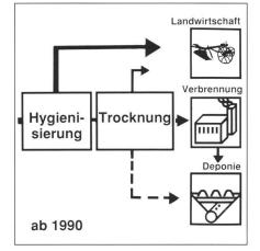
Abb. 5: Drei mögliche Wege des Klärschlamms. Während die Landwirtschaft von zentralster Bedeutung und die Verbrennung nötig ist, soll die Deponie als Übergangs- resp. Notlösung
