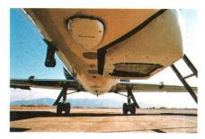
Abb. 4: Das am Learjet-Rumpf angefügte Camera-door mit NAV Rohr der RC-10 in der rechten Rumpfseite (Aufnahme Kurt Keller).
