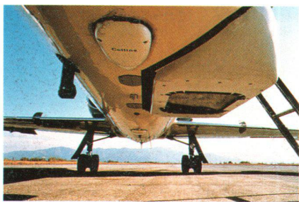
Abb. 4: Das am Learjet-Rumpf angefügte Camera-door mit NAV Rohr der RC-10 in der rechten Rumpfsseite (Aufnahme Kurt Keller).
