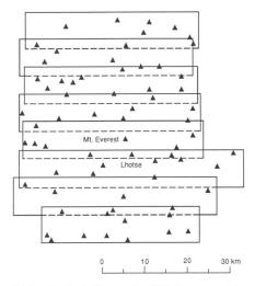
Abb. 11: Verteilung der MC-Passpunkte im Blockverband der Aerotriangulation.
