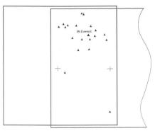
Abb. 10: Verteilung der Passpunkte zur absoluten Orientierung des MC-Stereomodells.
