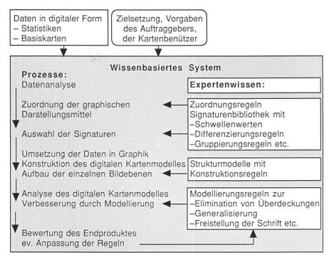
Abb. 1: Prinzip eines wissenbasierten Systems für die Kartographie.
