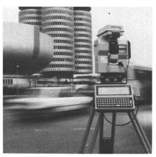
Messungen sind auch bei fliessendem Verkehr kein Problem: Der elektronische Präzisionstheodolit ETh 2, Spitzenmodell aus der Baureihe E von Carl Zeiss, hier zusammen mit dem Impulsdistanzmesser Eldi 10 und dem Feldcomputer Rec 500.
