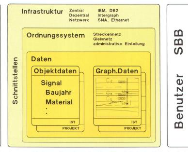
Abb. 1: Um den verschiedenen Benutzern den Zugriff auf die in der Datenbank der festen Anlagen verwalteten Informationen zu ermöglichen, müssen verschiedene Hilfsmittel bereitgestellt werden: Schnittstellen zur Kommunikation mit andern EDV-Systemen, eine technische Infrastuktur mit geeigneter Hard- und Software und ein Ordnungssystem, das die Verwendung von dem Benutzer gebräuchlichen Begriffen erlaubt.
