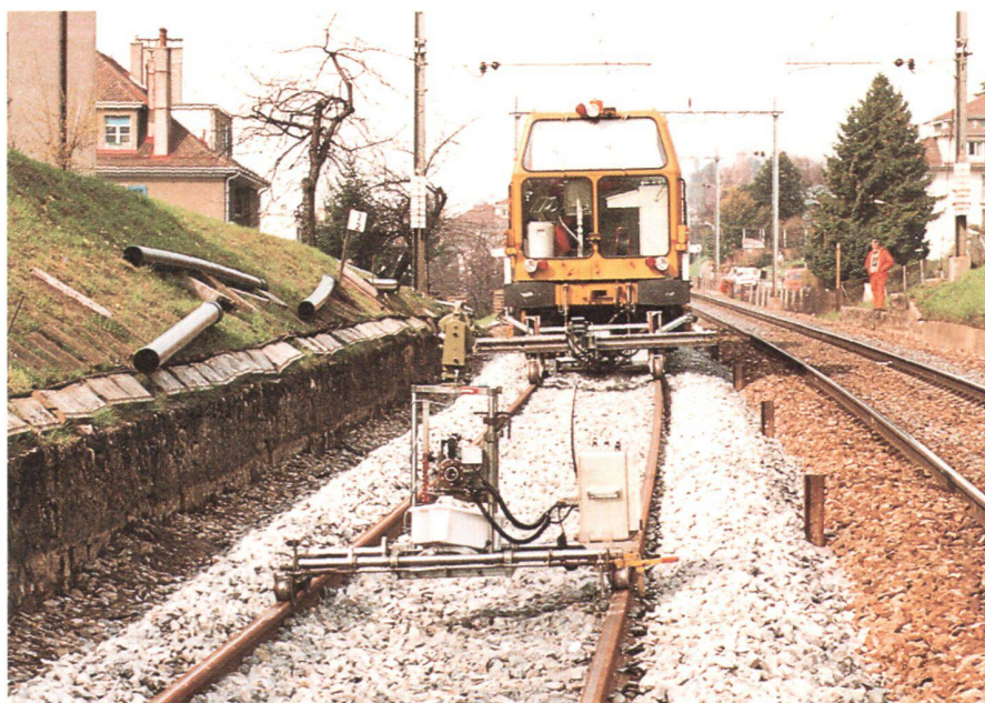
Abb. 10: Automatische Richt-, Nivellier- und Stopfmaschine ausgerüstet mit dem neuen Lasersystem. Mit dem Distanzmesser im Vordergrund wird die Horizontaldistanz und die Höhendifferenz zum Gleisversicherungspunkt gemessen. Der Bordcomputer ermittelt durch den Vergleich der Ist-Werte mit den Soll-Werten die effektive Schiebung bzw. Hebung in diesem Punkt.
