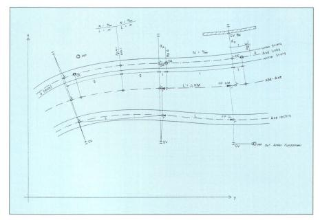
Abb. 2: Konzept der neuen Gleisversicherung.
