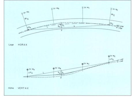
Abb. 11: Gleisgeometrie im relativen Messsystem.
