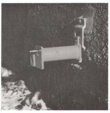
Abb. 3: Platte mit eingehängtem Verlängerungsstück. Die Verlegung des Bolzens als Bezugspunkt ermöglicht die Sichtverbindung zum nächsten Bolzen bei rauhen Tunnelwänden oder Einkragungen.
