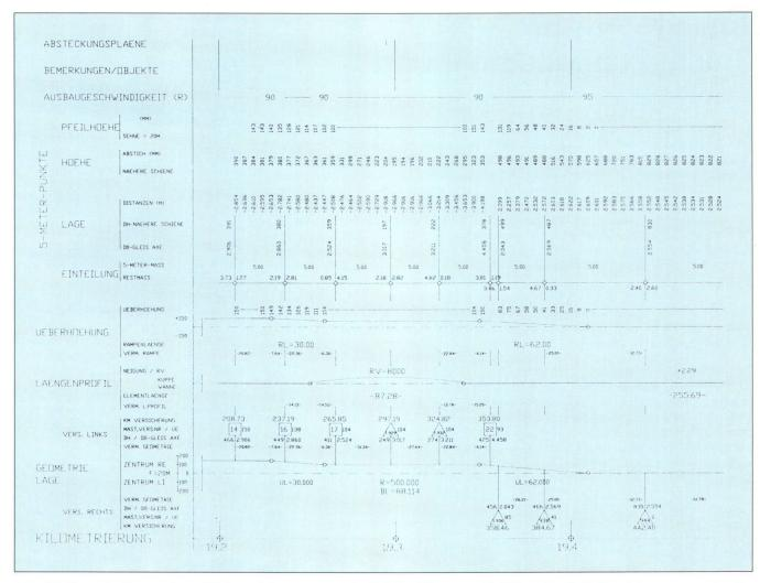
Abb. 13: Ausschnitt aus einem Gleisversicherungsprotokoll. Beim Kilometer 19.354 wechselt die Versicherung von der linken auf die rechte Gleisseite. Symbole:  $\square$  = Mastbolzen,  $\triangle$  = Tiefpunkt.
