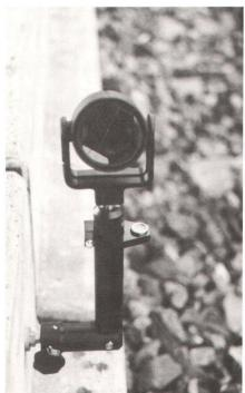
Abb. 6: Bei verdeckten Bolzen wird die «Perronhalterung» eingesetzt. Die Genauigkeit der Dosenlibelle von 10–15' ermöglicht eine milimetergenaue Höhenverlegung des Bezugspunktes.
