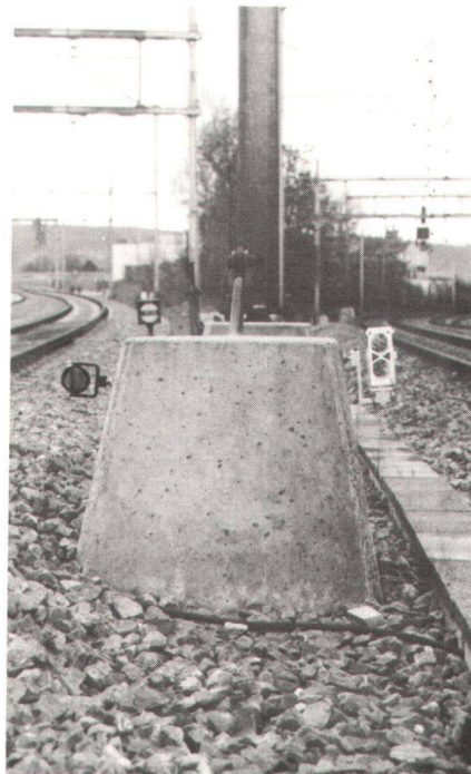
Abb. 5: Wildreflektoren (Typ GPH1) können direkt an den Bolzen gesteckt werden. Für Prismen, die zur Messung senkrecht stehen müssen, sind Haltebügel entwickelt worden.
