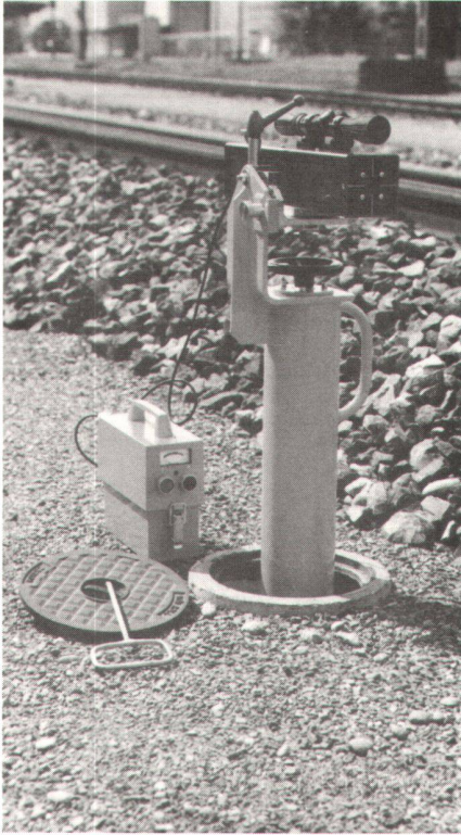
Abb. 4: Tiefpunktgestell mit eingerichtetem Laser für den manuellen Gleisunterhalt.
