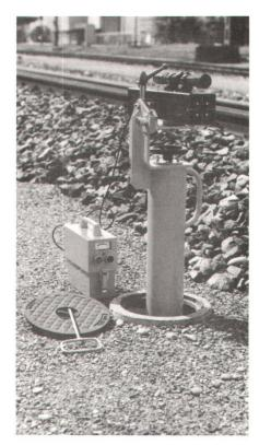
Abb. 4: Tiefpunktgestell mit eingerichtetem Laser für den manuellen Gleisunterhalt.
