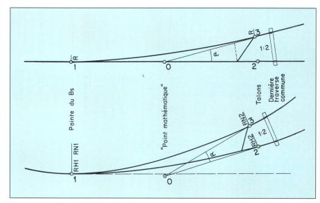
Fig. 1: Représentation schématique sommaire d'un appareil de voie du genre branchement simple placé sur une voie en alignement et une voie en courbe. L'angle  $\alpha$  est l'angle d'ouverture (tg $\alpha$  = 1:n). Le triangle 0, 2, 3 reste invariable.
