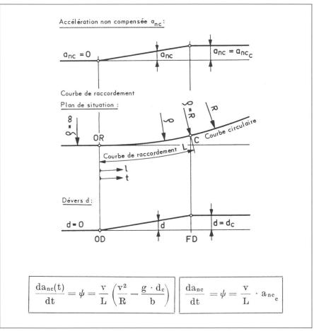
Fig. 4: Diagramme de la variation de l'accélération  $a_{\rm nc}$  et du dévers d en fonction de la longueur parcourue dans la courbe de raccordement. Deux formules donnant la variation de l'accélération en fonction du temps, ou choc, sont indiquées.
