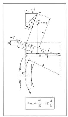
Fig. 3: Schéma des forces théoriques agissant sur le centre de gravité du véhicule et conduisant à la formule utilisée pour le calcul de l'accélération non compensée a<sub>ne</sub>.
