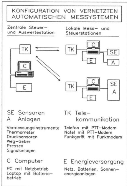
zumeist digital vorliegenden Messwerte ermöglichen heute computergesteuerte Mess-, Auswerte- und Kommunikationssysteme, deren Entwicklung wohl erst am Anfang steht.
