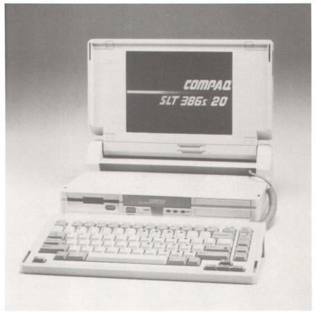
sen und gewohntem Tastenabstand. Der 10" grosse VGA Backlit LCD Monitor ist unter allen Lichtbedingungen sehr gut lesbar.
