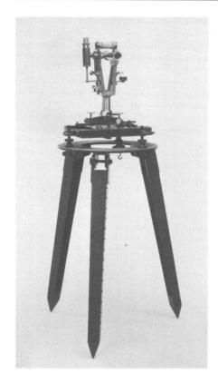
Abb. 3: Kleiner Absteckungstheodolit auf Eisenstativ. Die Fussschrauben stehen in Bohrungen der Zentriervorrichtung. Gewicht des Stativs mit der Zentriervorrichtung = 70 kg.
