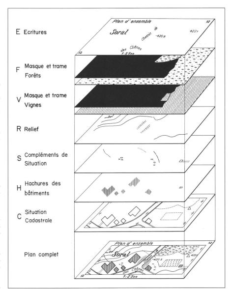
Fig. 2: Principe de réalisation du plan d'ensemble par couches séparées. Herstellungsprinzip des Übersichtsplanes aus verschiedenen Ebenen.
