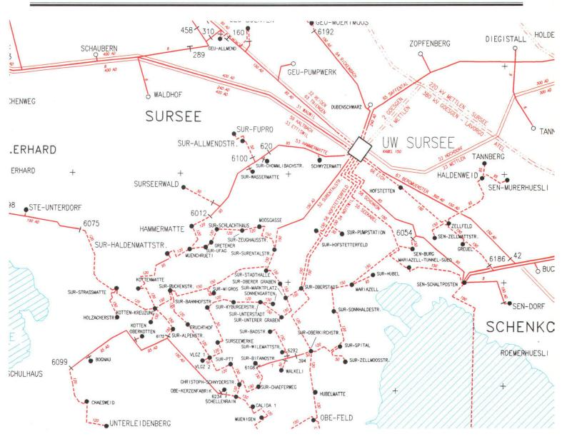
Abb. 2: Netzplan Mittelspannung (Massstab 1: 25 000).
