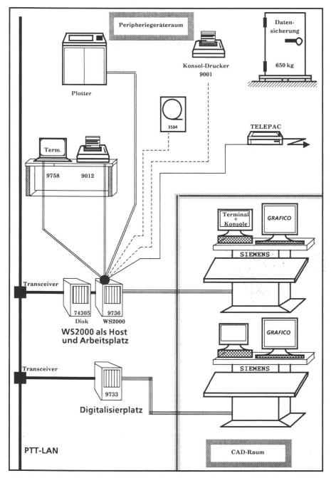
Abb. 2: Startkonfiguration GRAFICO: Peripheriegeräteraum mit Rechner, Plotter und Drucker; CAD-Raum.
