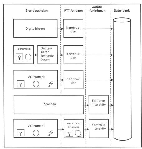
Abb. 1: Varianten der Erstdatenerfassung: Grundbuchplan – PTT-Anlagen – Zusatzfunktion – Datenbank.
