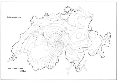
Abb. 3: Unterschiede in den GPS-Höhen, verursacht durch verschiedene Meteo-Modelle.
