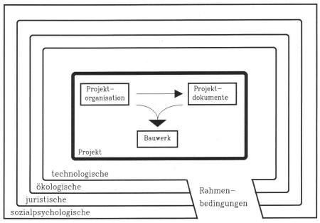
Abb. 5: Das Bauprojekt – ein System (nach [6]; modifiziert).
