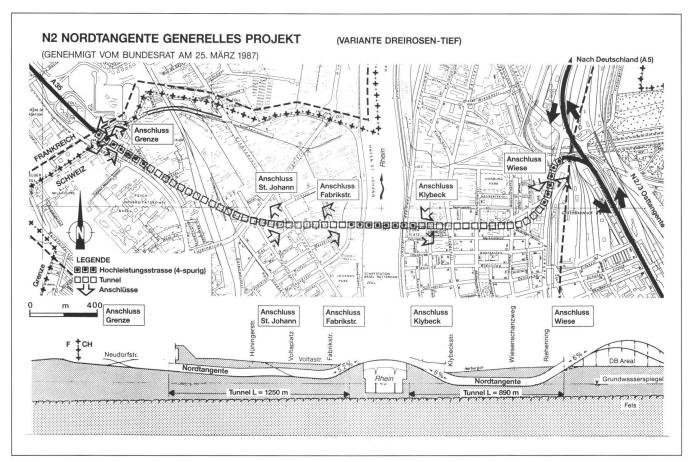
Abb. 2: Situation und Längsschnitt des genehmigten Generellen Projektes.
