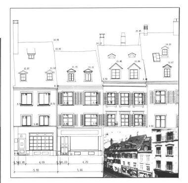
Rationellere Vermessungsergebnisse durch Rolleiflex 3003 metric und Rolleimetric Software
