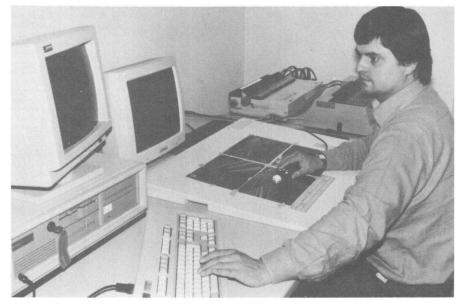
Abb. 2: Das Auswertesystem: Rolleimetric MR2/CAD.
